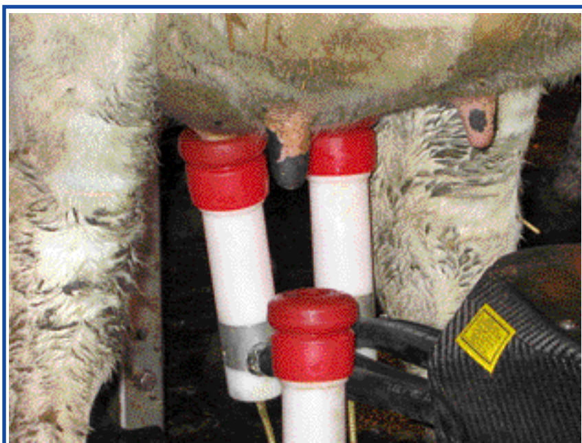
Innan mjölkningen börjar har roboten lokaliserat alla spenar. Tvättat med borstar och desinfektionsmedel och håller här på att aptera för mjölkning
