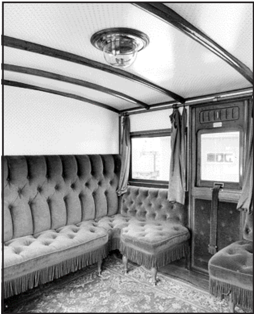
Kupéljus användes till belysning i tågans kupéer. De satt i taket på vagnarna och ljusbyte skedde från utsidan av taket, säger Åke. Detta är en förstaklassvagn från järnvägens barndom.
